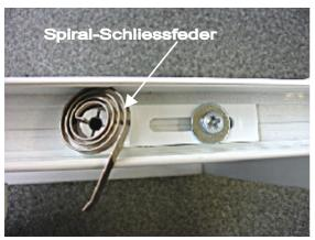
2. Feder mit dem kurzen Schenkel in das Scharnieroberteil einsetzen.
