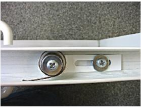
4. Verschraubung: U-Scheibe und Linsenkopfschraube 6 x 70
